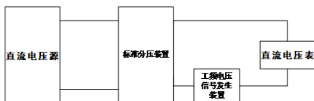
图 3 跨步电位差弱电压测量抗工频干扰试验
