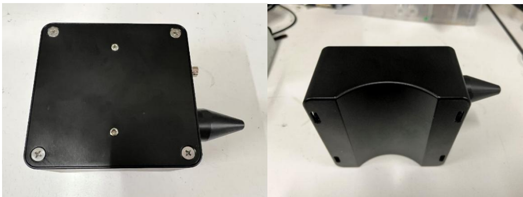
图 B. 2 超声局放-振动-温升一体化传感器封装结构实物图
