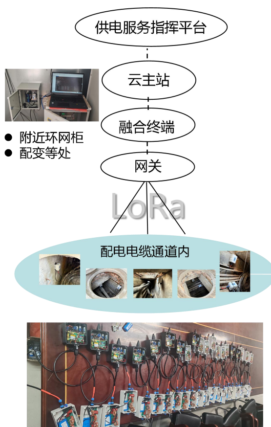
图 B.1 某公司配电电缆分布式状态监测网络架构
