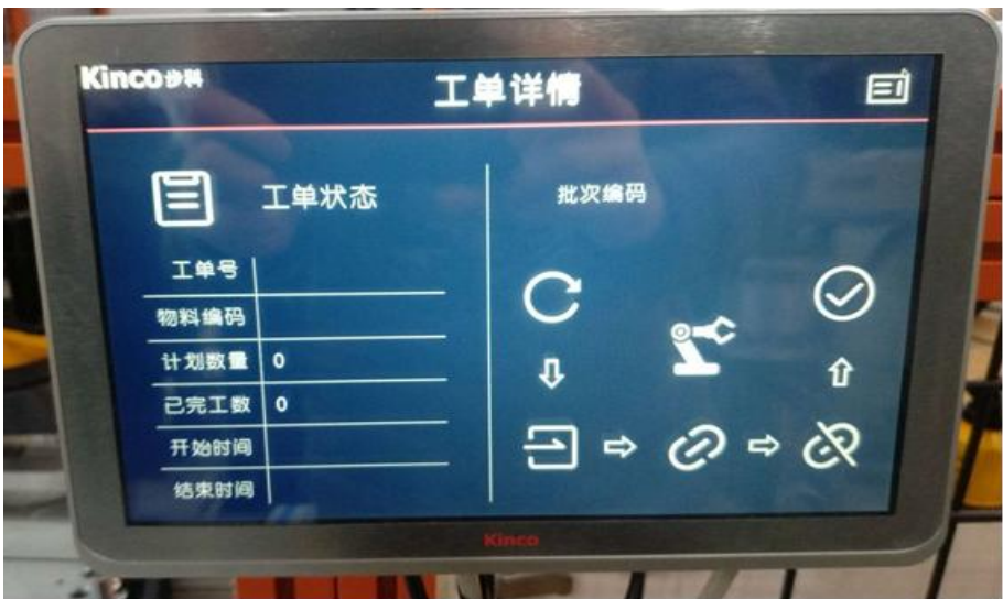
图 2 产线数据采集及管理系统界面
