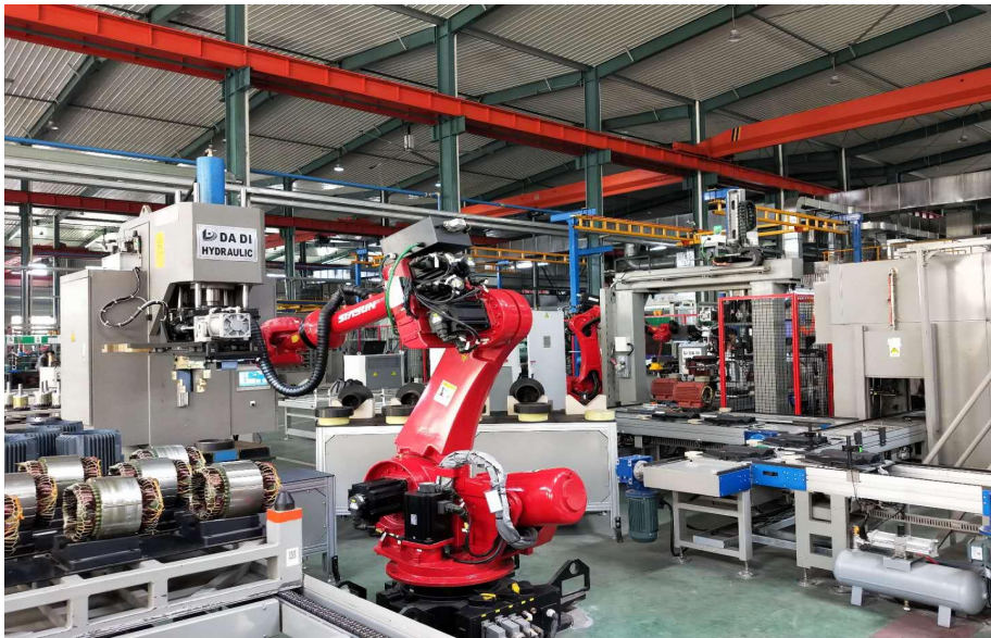
图 1 电机数字化装配生产线
